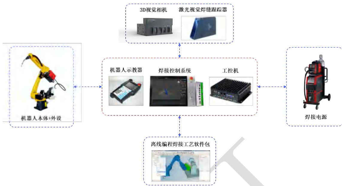
图表 3 智能焊接机器人系统构成
